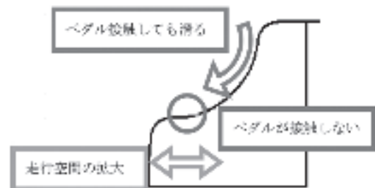
図-3 ペダル接触回避型縁石コンセプト
