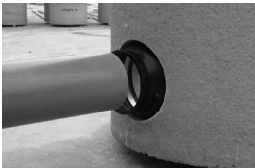
写真-10 管渠の挿入状況
