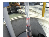
浮遊物(油)の測定
