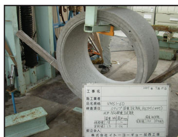
水平方向荷重試験(異常なし)
