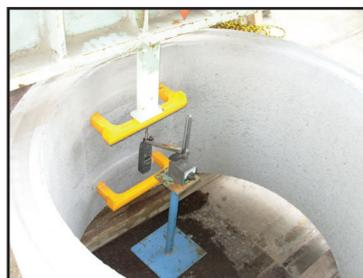
垂直方向荷重試験 (歪み5.4mm)
