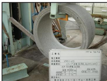
水平方向荷重試験 (異常なし)
