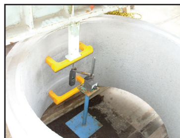
垂直方向荷重試験 (歪み5.4mm)
