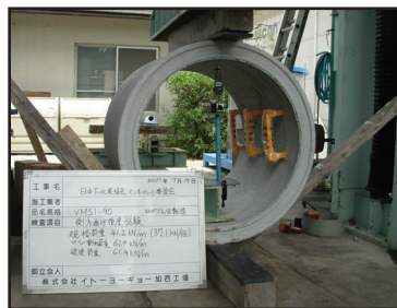
側方曲げ試験 (1号マンホール 試験値 61.9 kN/m)
