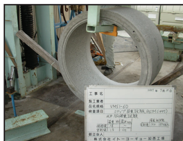
水平方向荷重試験 (異常なし)
