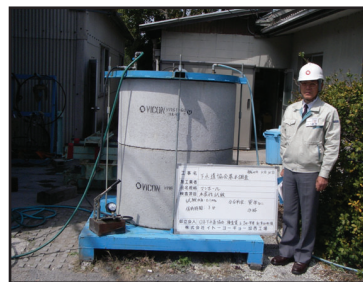
水密性試験 (1号マンホール 0.1 MPa・3分)
