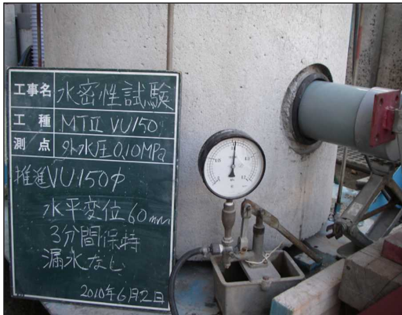
写真 - 3 水平変位を与えた場合の水密試験状況
