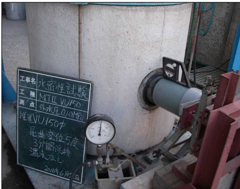
写真 - 2 屈曲変位を与えた場合の水密試験状況
