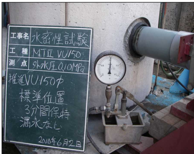
写真 - 1 通常位置の水密試験状況
