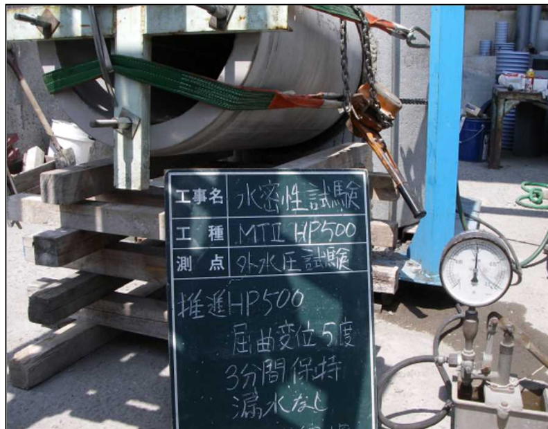
図 - 2 屈曲変位を与えた場合の水密試験装置
